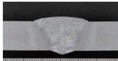
溶接部のマクロ観察例
