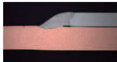
ステンレス鋼と銅におけるレーザブレイジング例
